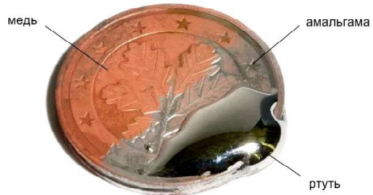
Рис. 4. Образование ртутной амальгамы при смачивании поверхности медной монеты
