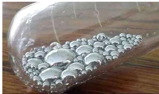
Рис. 3. Ртуть плохо смачивает даже... саму себя и потому легко разбивается на отдельные капли
